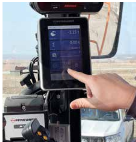
Touchpad-Monitor im Radlader
