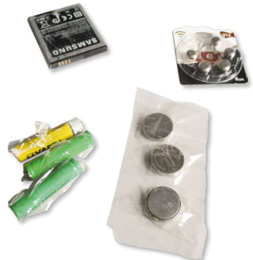
Abbildung 2: So werden Knopfzellen und Batterien kurzschlussgesichert
