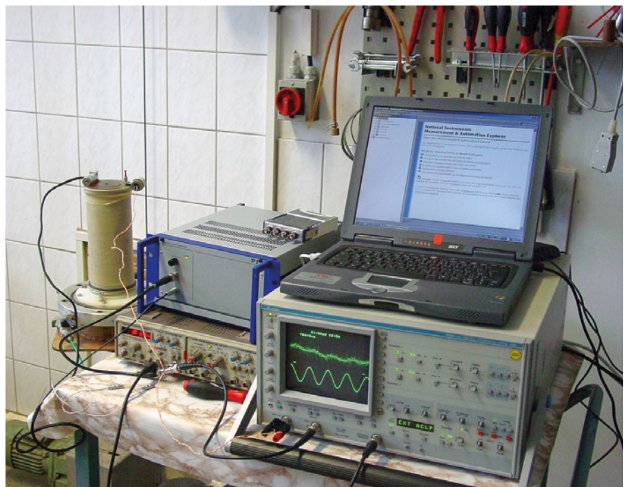
Beispiel einer Verfahrensentwicklung am Triaxialgerät (Versuchsaufbau)
